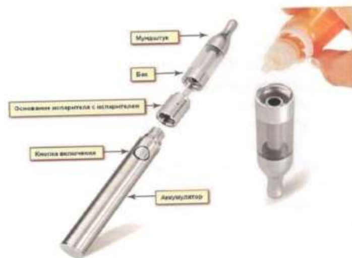
Рис. 3. Устройство электронной сигареты
